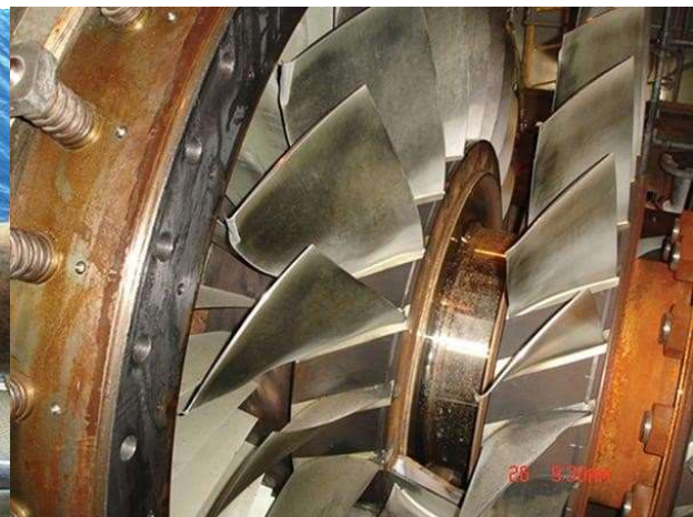
Kompresszorlapátok sérülése korábban fel nem tárt vízvezeték lyukadása miatt, amely jégképződést eredményezett a hidegben
