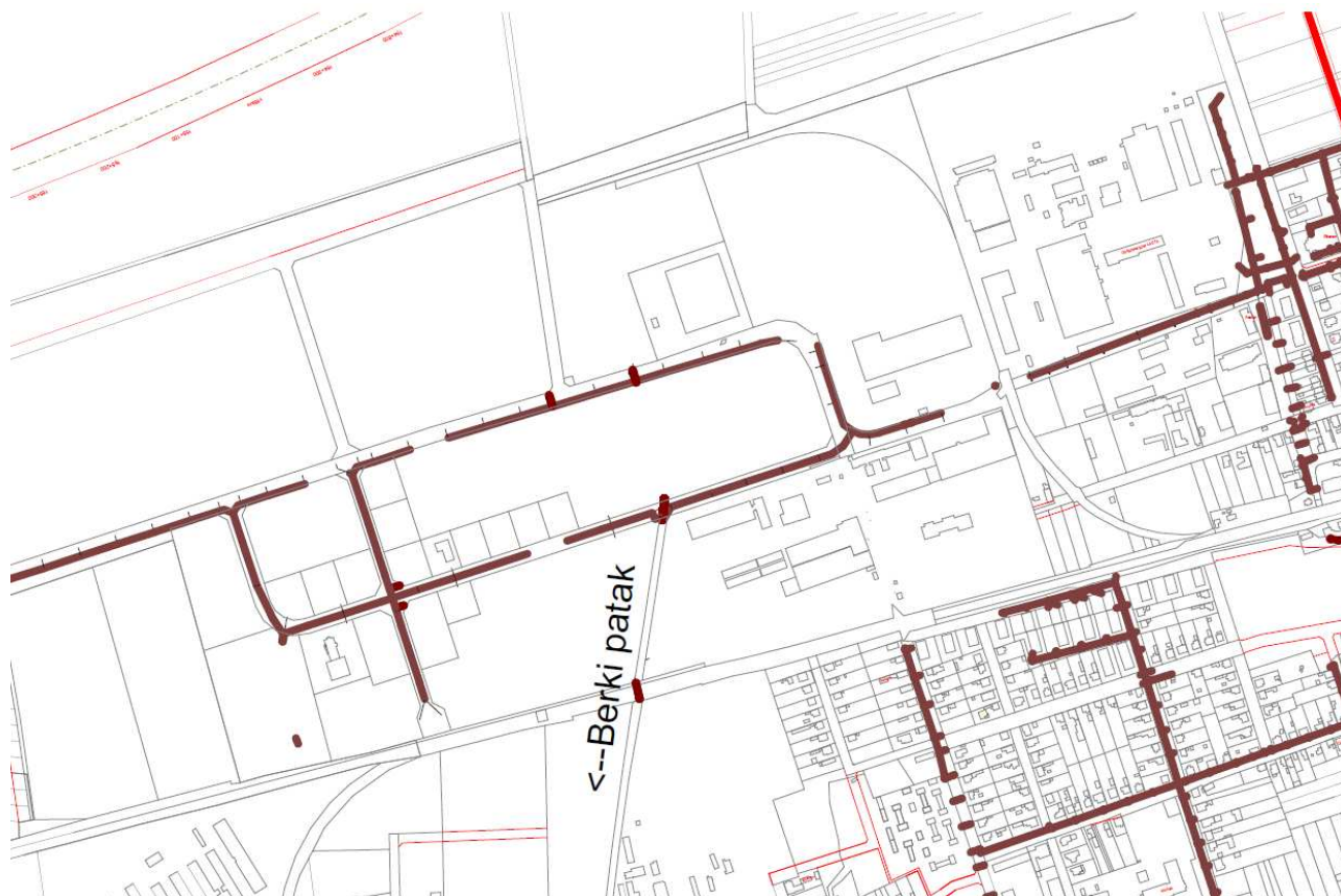
Zárt csapadékvíz elvezető rendszer Körmenden (részlet)
