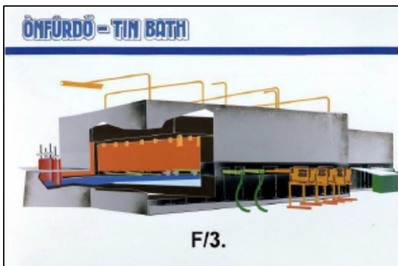
3.ábra A float-üveg gyártási technológia
