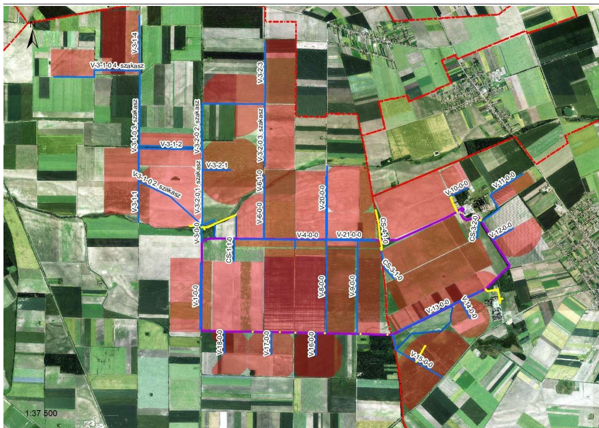
8. ábra: Az öntözőtelep meglévő körvezetéke (lila), a tervezett nyomóvezetékek (kék) és a tervezett kútbekötő vezetékek (sárga)
