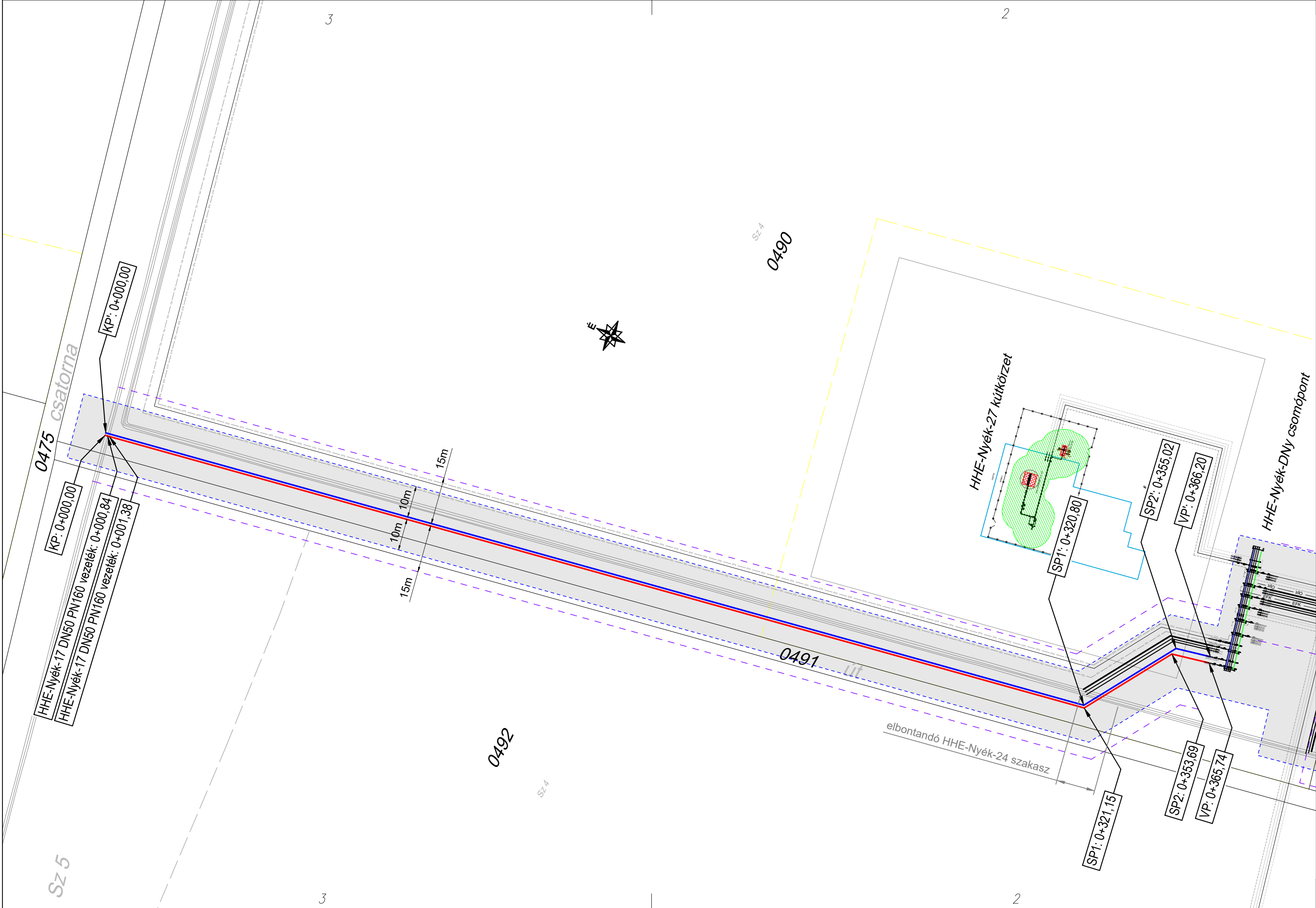
HHE-Nyékpuszta-17 DN100 PN160 vezeték bekötés jellemző pontjai
