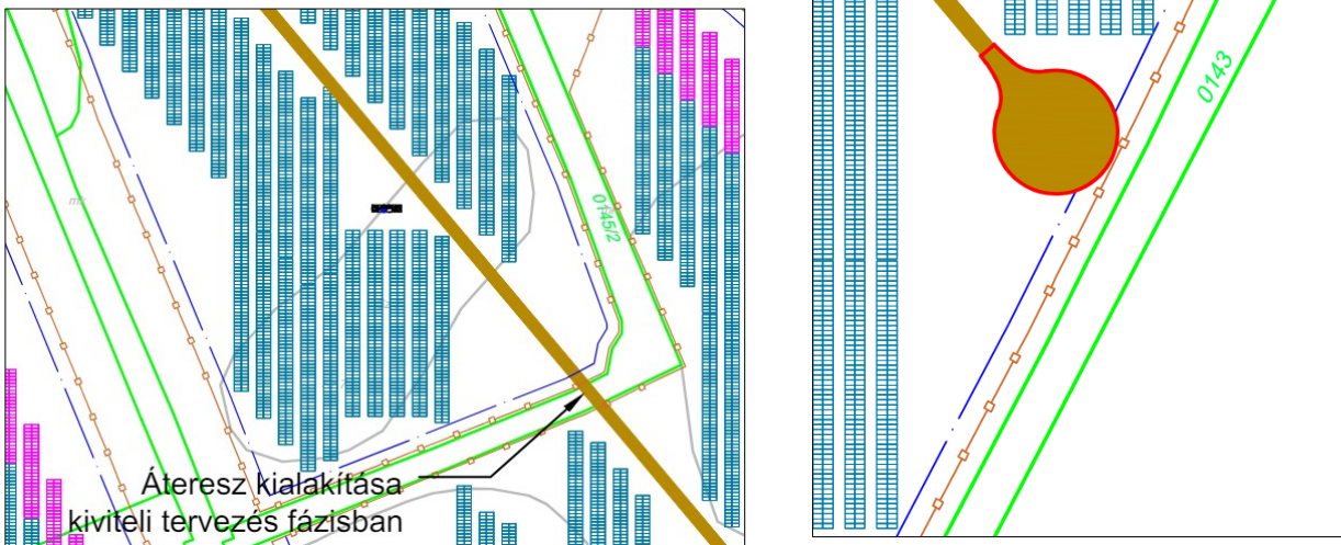
2.-3. ábra Csapadékvíz-elvezető árok érintettségének területe és a kerítés által érintett
