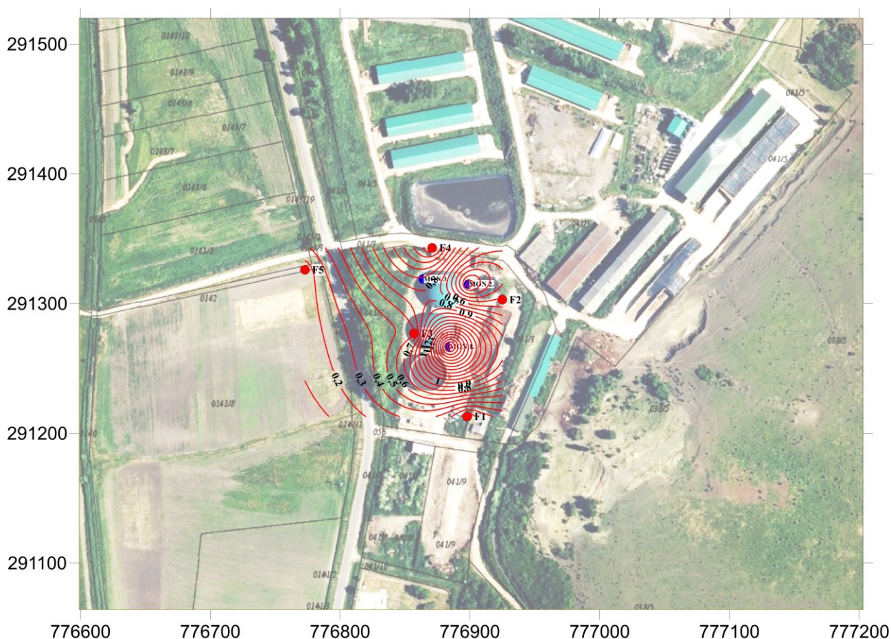
4. ábra Ammóniumion eloszlása a talajvízben a felülvizsgálat idején
