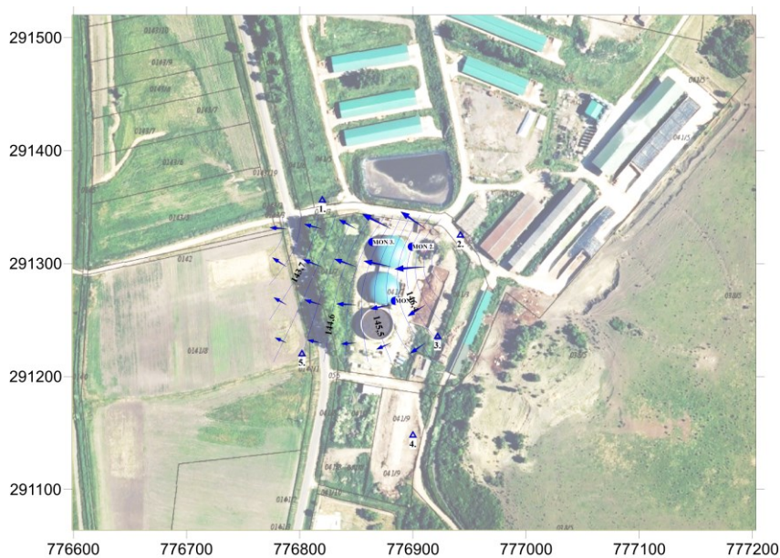
10. ábra Korábbi mérések alapján meghatározott szivárgási irány
