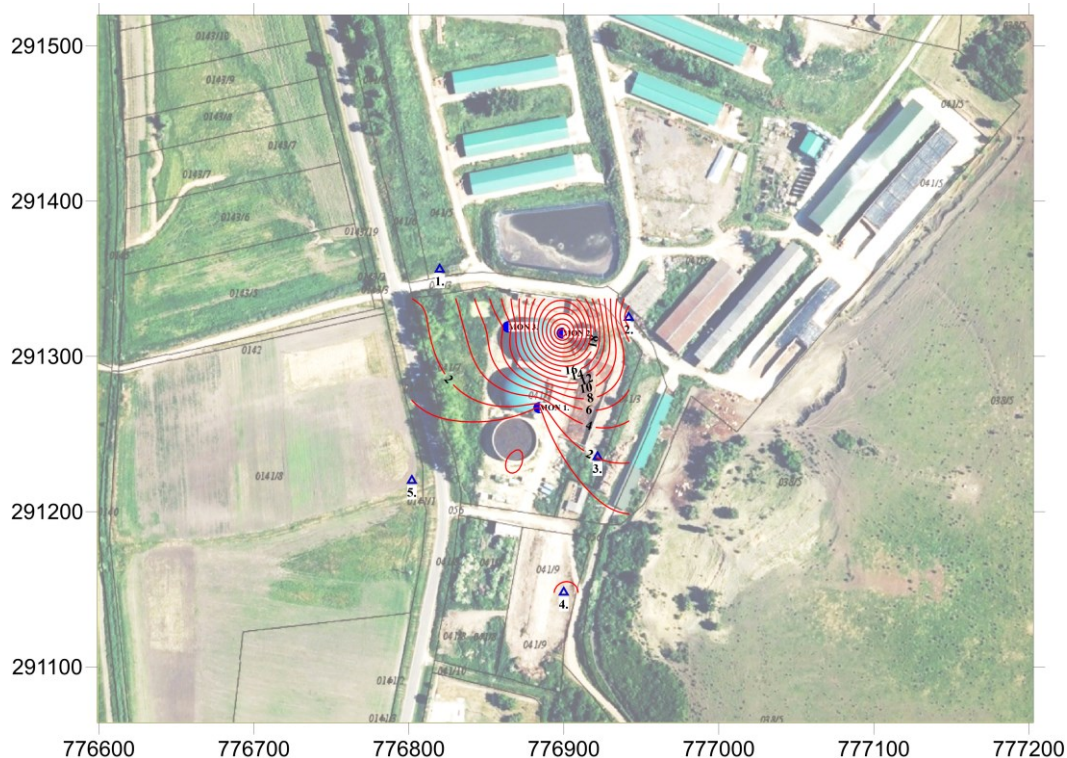
7. ábra Nitrát eloszlása a talajvízben a 2020. nyári mérések idején
