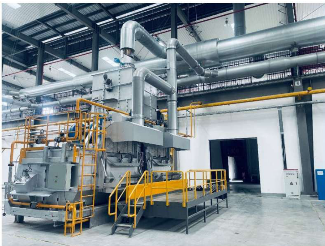
4-3. ábra Olvasztókemence felépítése
