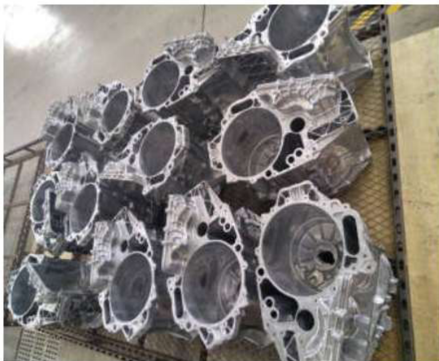
4-16. ábra Hőkezelésre váró öntvények egy fémrácson
