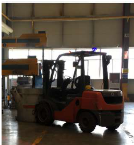
4-6. ábra Öntőüst mozgatás targoncával
