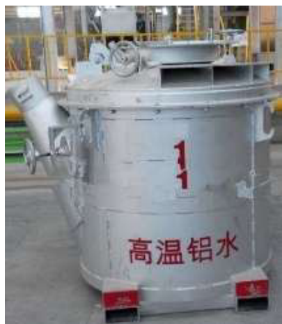
4-5. ábra Öntőüst felépítése
