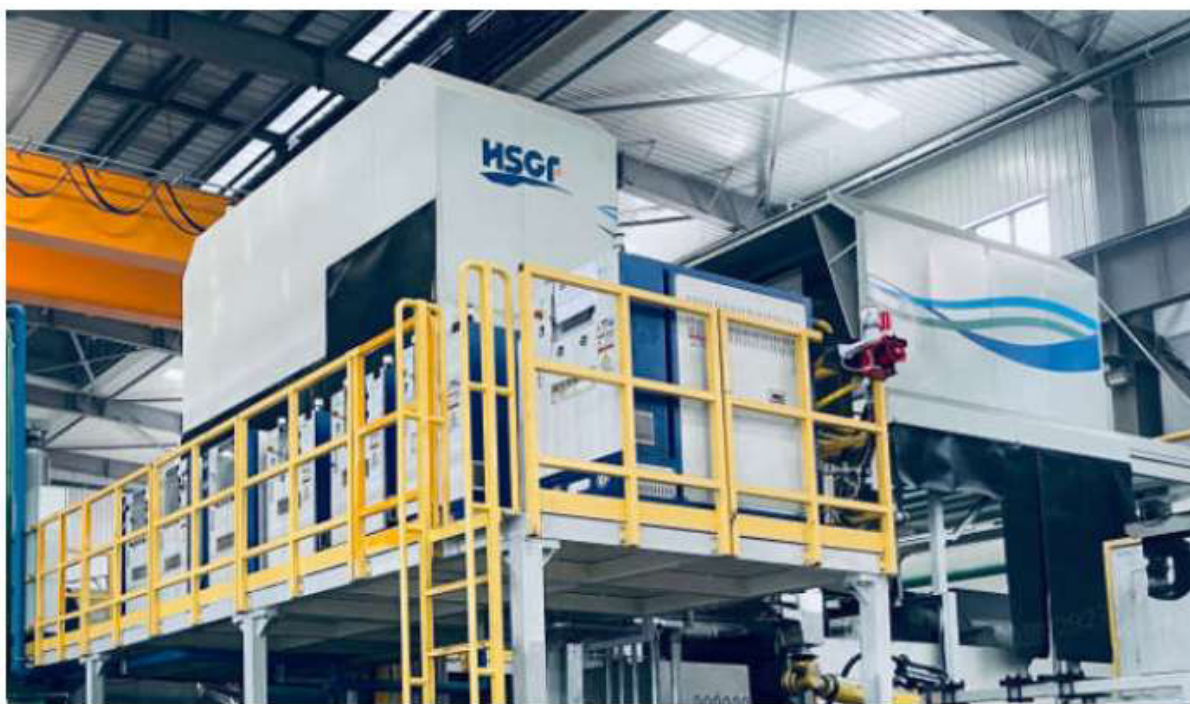
4-10. ábra Nyomásöntő gép feletti gázgyűjtő ernyő
