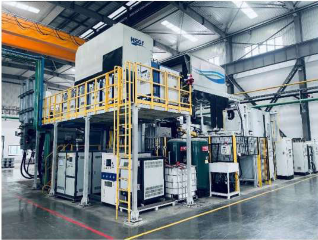
4-9. ábra: Nyomásöntő berendezés elrendezés sziget
