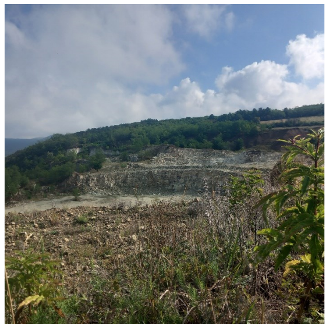
5-6. ábra: Többszintes külszíni fejtés a Rátka V. zsoitbányában.
