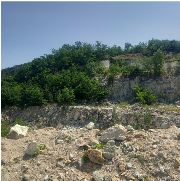
5-6. ábra: Többszintes külszíni fejtés a Rátka V. zsoitbányában.
