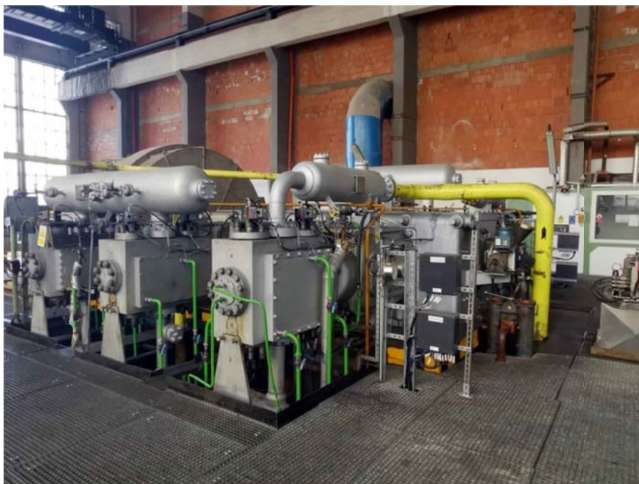
7. kép VII-OK-NP kompresszor egység. Ez 6 db, boxer elrendezésű dugattyúból áll, a képen, az egyik oldalon lévő három jól kivehető. A sárgák gázvezetékek, a vastag kék cső a villanymotor friss hűtőlevegő vezetéke
