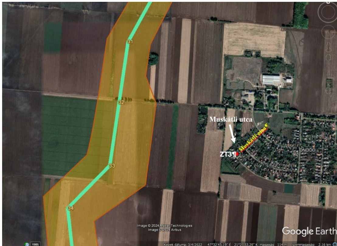
5. ábra: Zajvédelmi hatásterület a kivitelezési fázisban (narancssárga vonal és terület) Ondód környezetében
