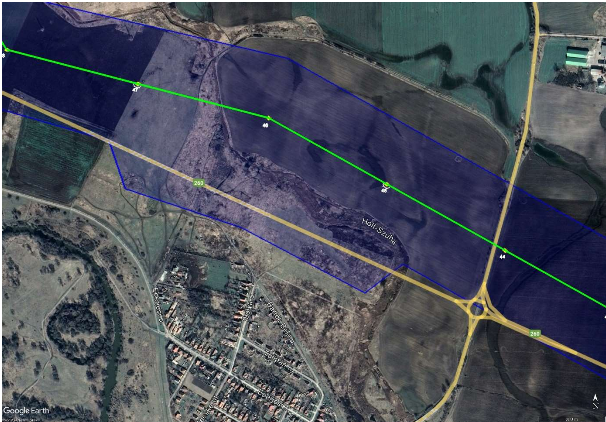
34. ábra: Zajvédelmi hatásterület a kivitelezési fázisban (kék vonal és terület) Sajószentpéter környezetében
