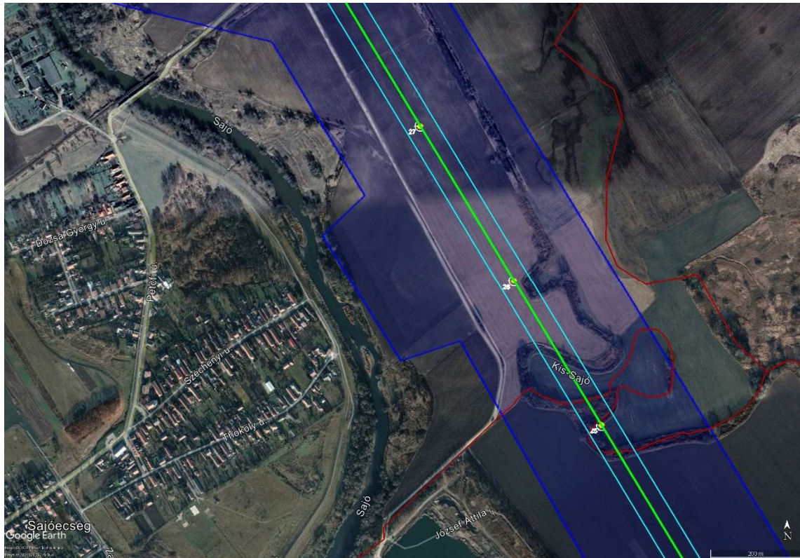
2. ábra: Egyesített hatásterület a kivitelezési fázisban (kék vonal és terület) Sajócség településrész környezetében lévő nyomvonalszakaszon (zöld vonal: nyomvonal; türkiz vonal: biztonsági övezet sávja)
