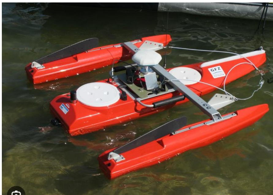
26. ábra: Teledyn WorkHorse Rio Grande 600 kHz vízhozam-mérőberendezés.
