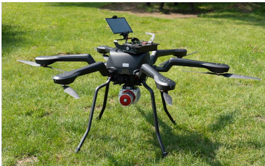
13. ábra: Acecore Noa drón Riegl VUX-1LR légi lézerszkennelrel.
