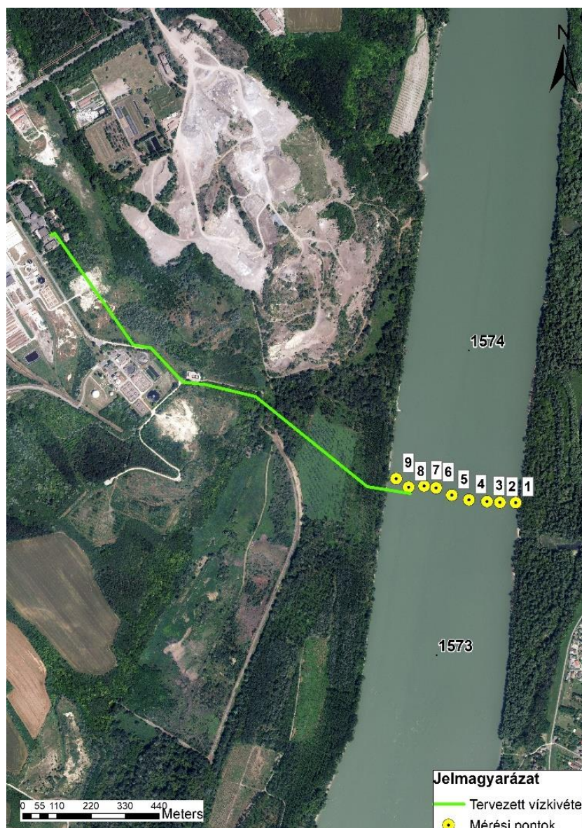
48. ábra: A fenékcúsztató feszültségek megállapításához használt mérési pontok.
