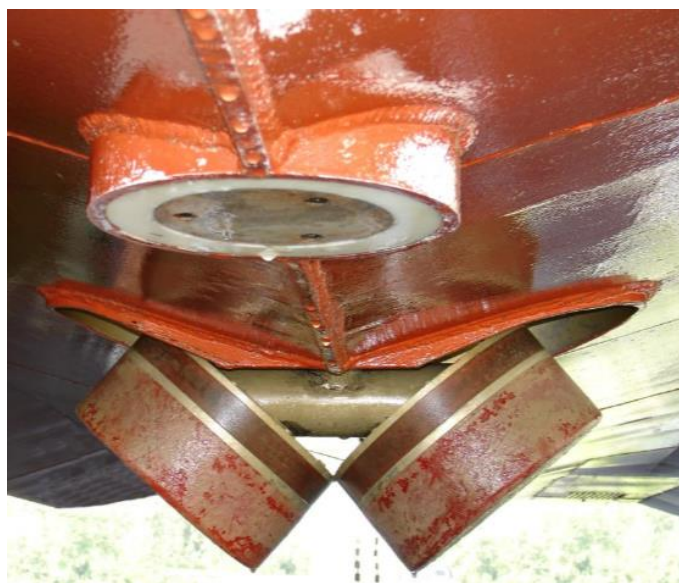
23. ábra: Egy és többsugaras ultrahangos mélységmérő (Multibeam).
