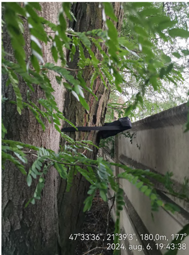
5. kép. Az útszegély nyugati oldalára kihelyezett ultrahangdetektor
