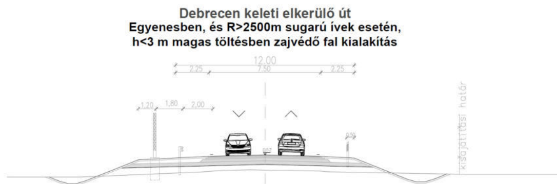
2. ábra. Mintakeresztmetszvény – tervezett Debrecen keleti elkerülő zajárnyékoló fal kialakítással
