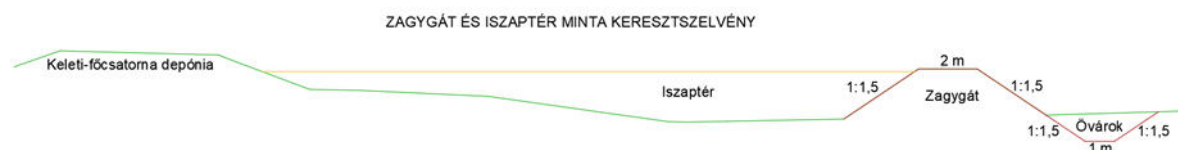
3. ábra: Zagygát és zagyter mintakeresztmetszelvénye
