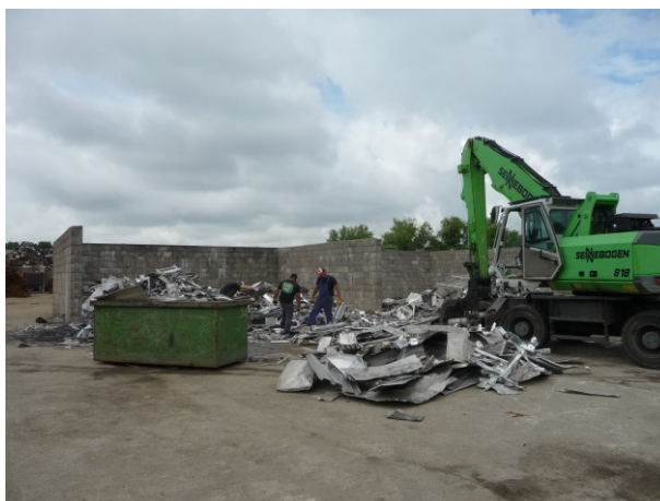
A dolgozók a hulladék-anyag szétválogatás végzik az egyik SENNEBOGEN rakodógép segítségével. A fotón látszanak az anyagtároló kazetták.
