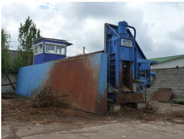
Az ATM betonvas és kábeldaraboló, bálázó gép heti 10 órát üzemel
