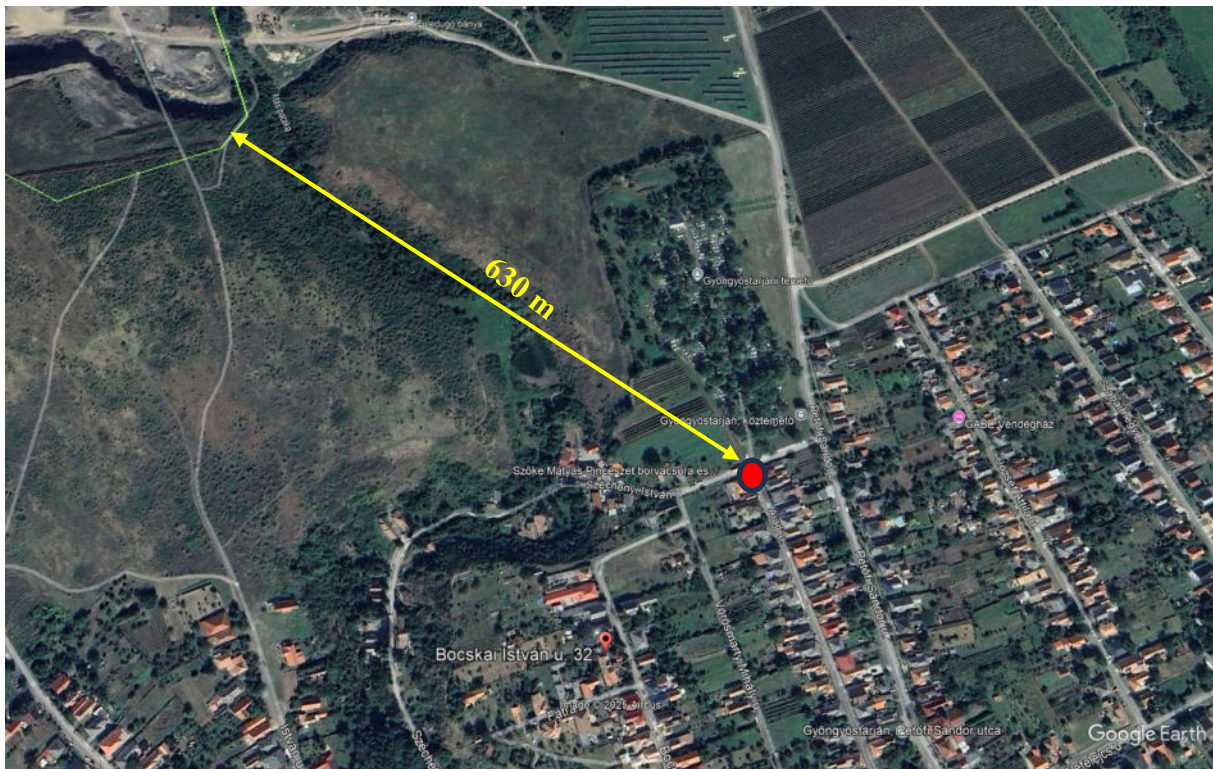
7. ábra: A 2024.10.02.-án végzett robbantás során a rezgési sebesség mérésének helye
