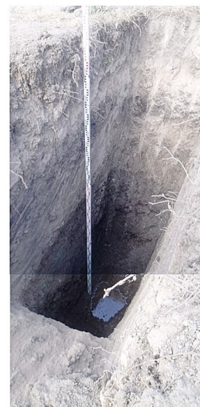
I. prg., 3,3 m mélyen jelentkező talajvízzel
