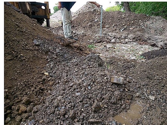
III. prg., víz alóli kavicsminta (4,2 m mélyről)
