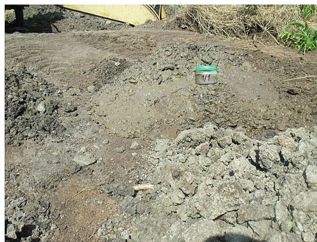
Víz alól vett kavicsos talajminta (II. prg., 3,7 m)
