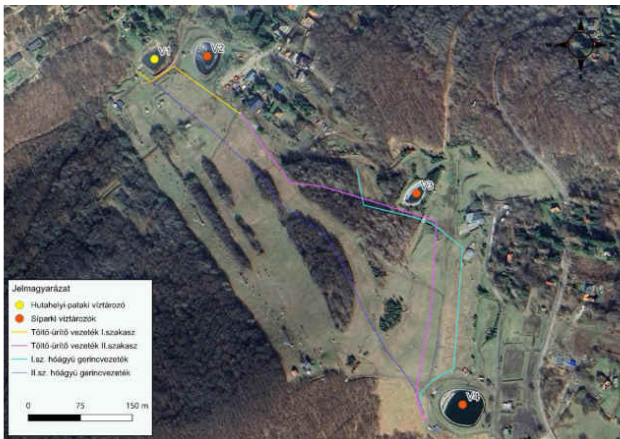
18. ábra Mátraszentistván sípark tározók, töltő-ürítő és hóágyú gerincvezetékek
