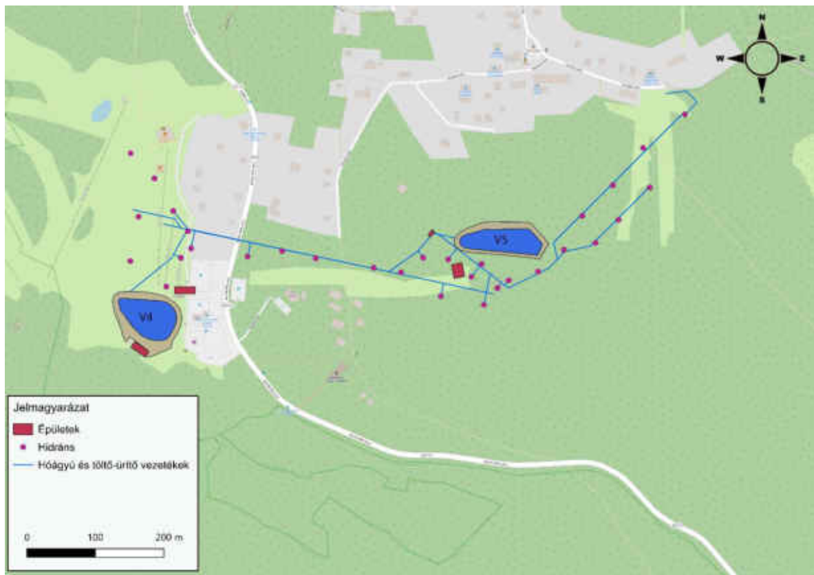
21. ábra Mátraszentistván sípark tervezett tározók és töltő-ürítő, valamint hóágyú gerincvezetékek
