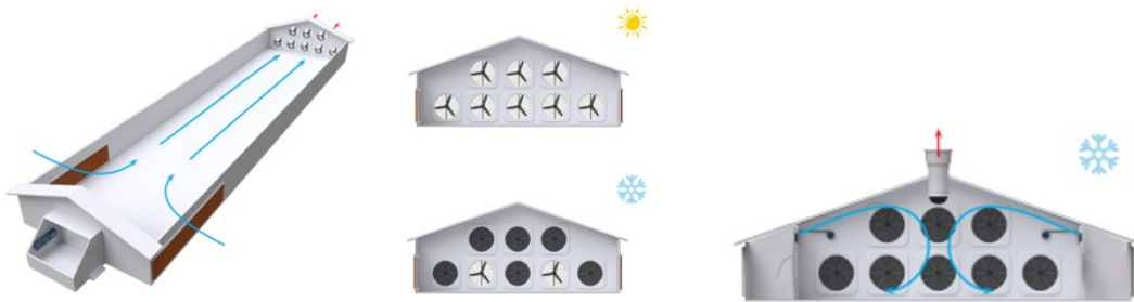
15. ábra: Szellőzőrendszer működési vázlatai (forrás: Műszaki technológiai leírás)
