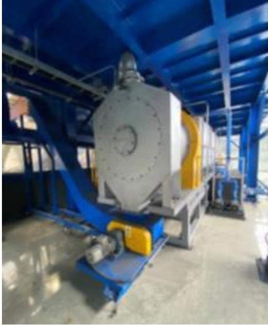
22. ábra: A forgó dobszárító hűtőegysége és a hozzá tartozó hőszivattyúk
