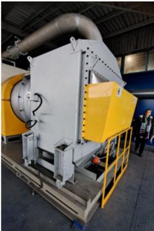
21. ábra: A forgó dobszáritó szárítóegysége
