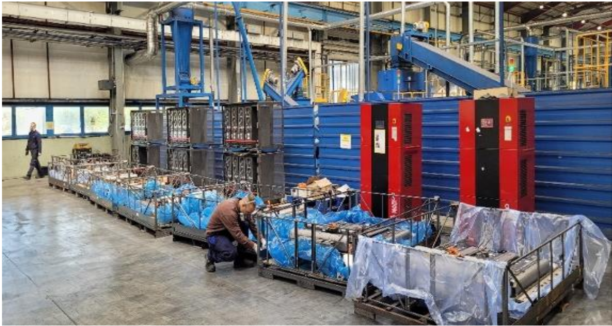
15. ábra: Az akkumulátorpack lemerítésének folyamata
