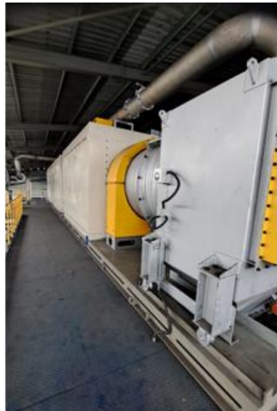
21. ábra: A forgó dobszáritó szárítóegysége
