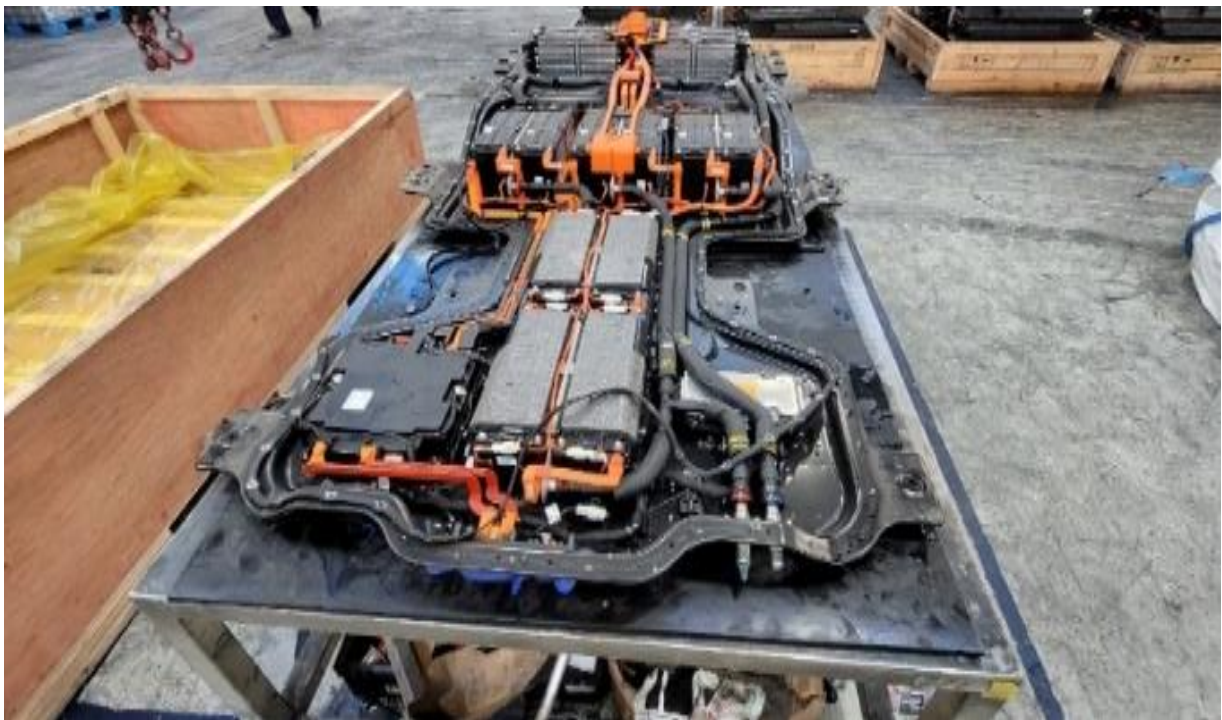
16. ábra: Szétszerelés alatt álló akkumulátorpack
