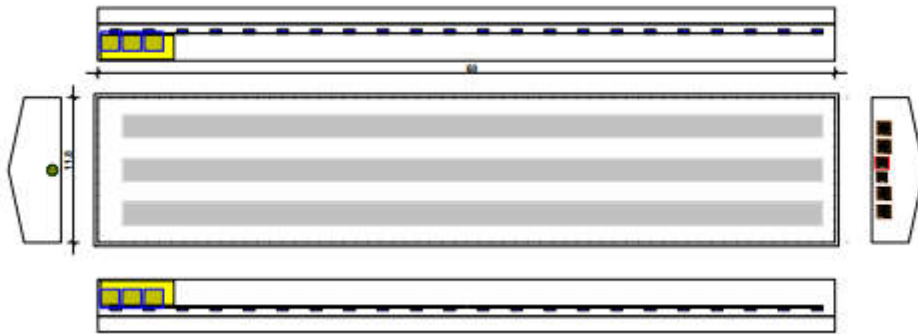
5. számú ábra: Megvalósítani kívánt jércenevelő istálló szellőző rendszer sémája
