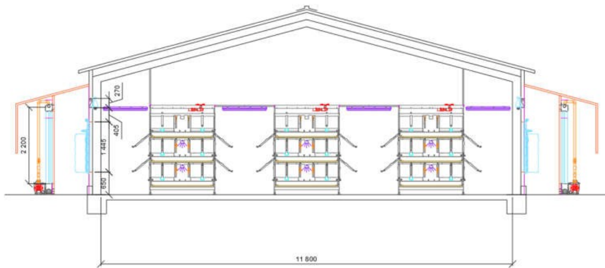
3. számú ábra: NATURA Primus 1800 nevelő istálló belső közmű csatlakozások rajza
