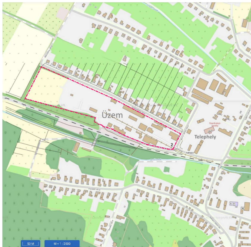
10-2. ábra: Vizsgált üzem közvetlen környezete a zaj ellen védendő épületekkel
