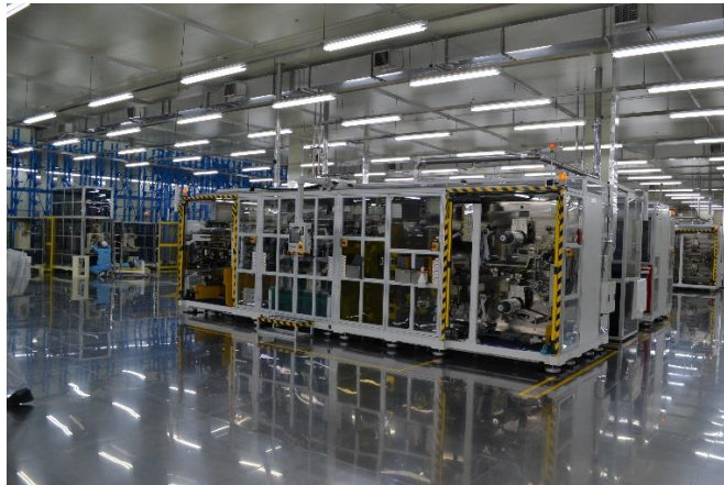
Tekercsről tekercsre típusú punching gép a 301 épület elektróda részterületének végén
