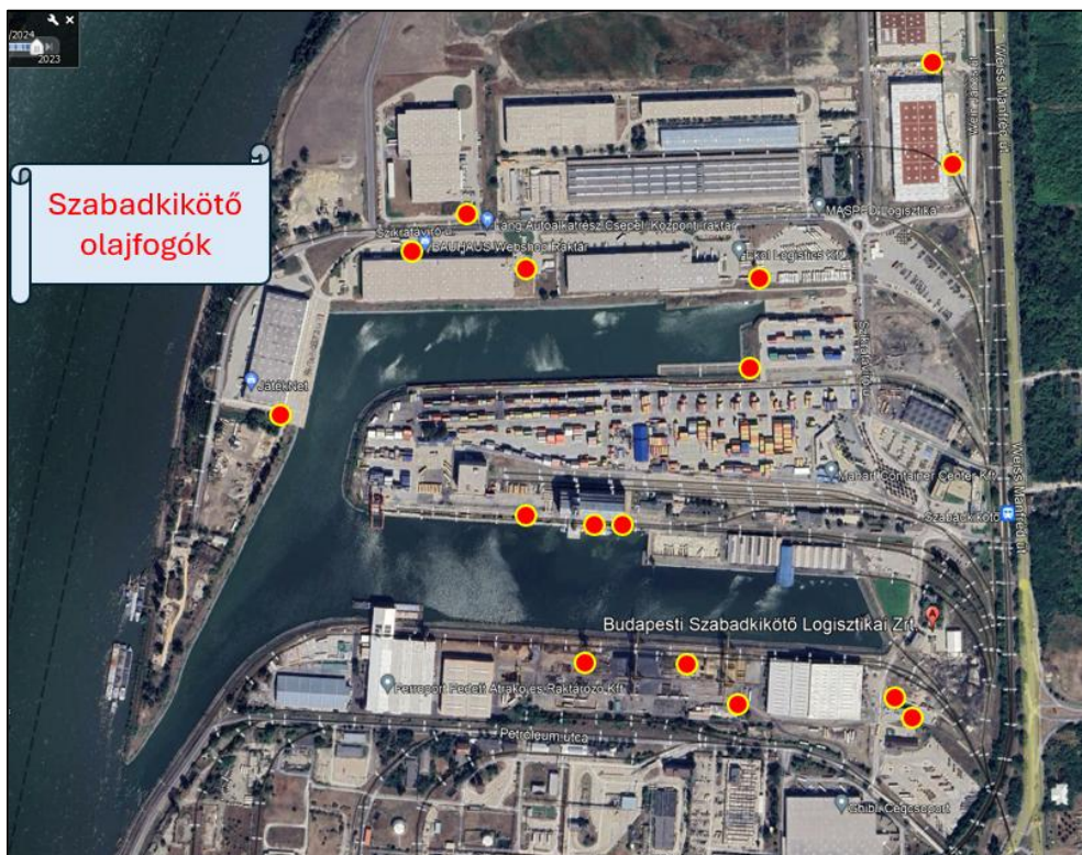
9. ábra: A Szabadkikötő területén üzemelő olaj-iszapfogó műtárgyak elhelyezkedése
