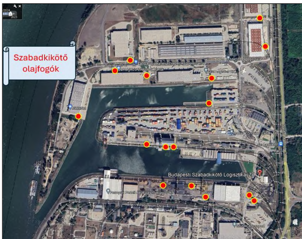
19. ábra: A Szabadkikötõ területén üzemelõ olaj-iszapfogó mûtárgyak elhelyezkedése
