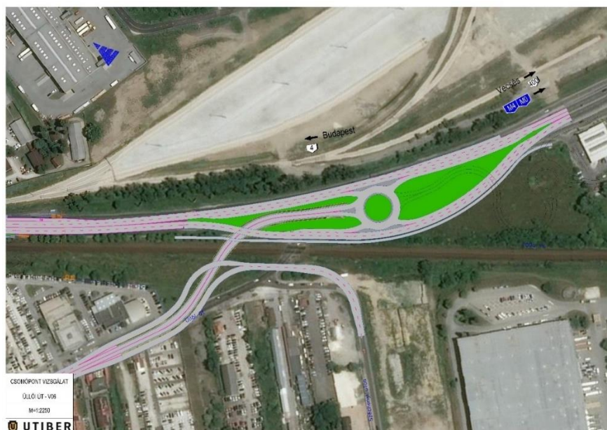
13. ábra A külső Üllői úti közúti és MÁV 100a vv. külön szintű csomóponti rendszer V06 változat
