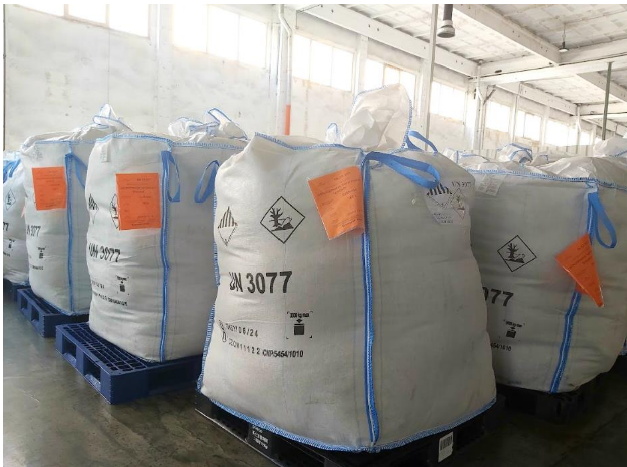
10. ábra: Jellemző tárolási mód az üzemcsarnokban: veszélyes hulladék kettősfalú ADR-minősített big-bag zsákban, feliratozottan (06 03 15* azonosító kódú katódhulladék)
