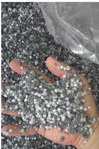
1. kép Műanyag hulladékból készült könnyűbetonhoz adalék alapanyag
