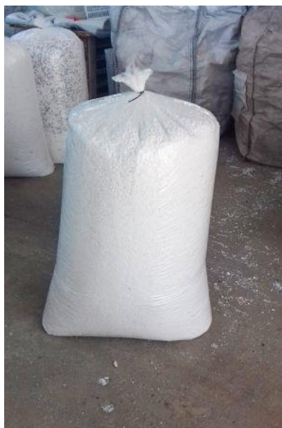
1. kép Műanyag hulladékból készült könnyűbetonhoz adalék alapanyag
