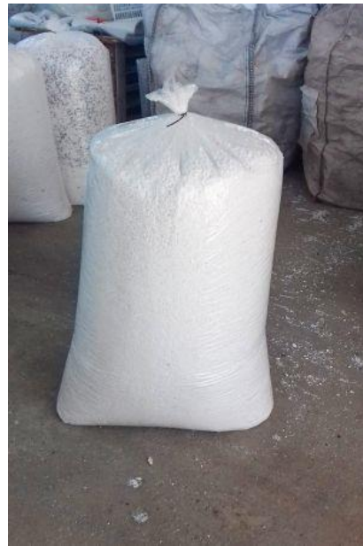
2. kép Műanyag hulladékból készült könnyűbetonhoz adalék alapanyag
