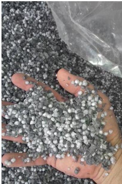
2. kép Műanyag hulladékból készült könnyűbetonhoz adalék alapanyag
