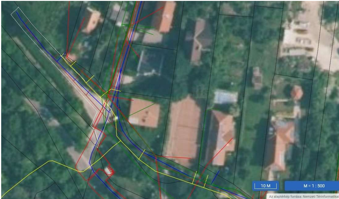
15. ábra: A tervezet útszakasz (fehér vonallal határolva) és a közművek elhelyezkedése
