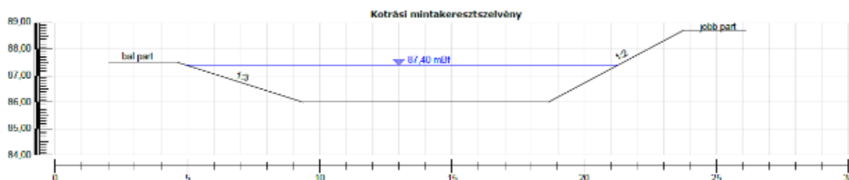
29. ábra Kotrasi mintakereszt-szelvény (Forrás: Vízjogi létesítési engedélyes terv (2025))
