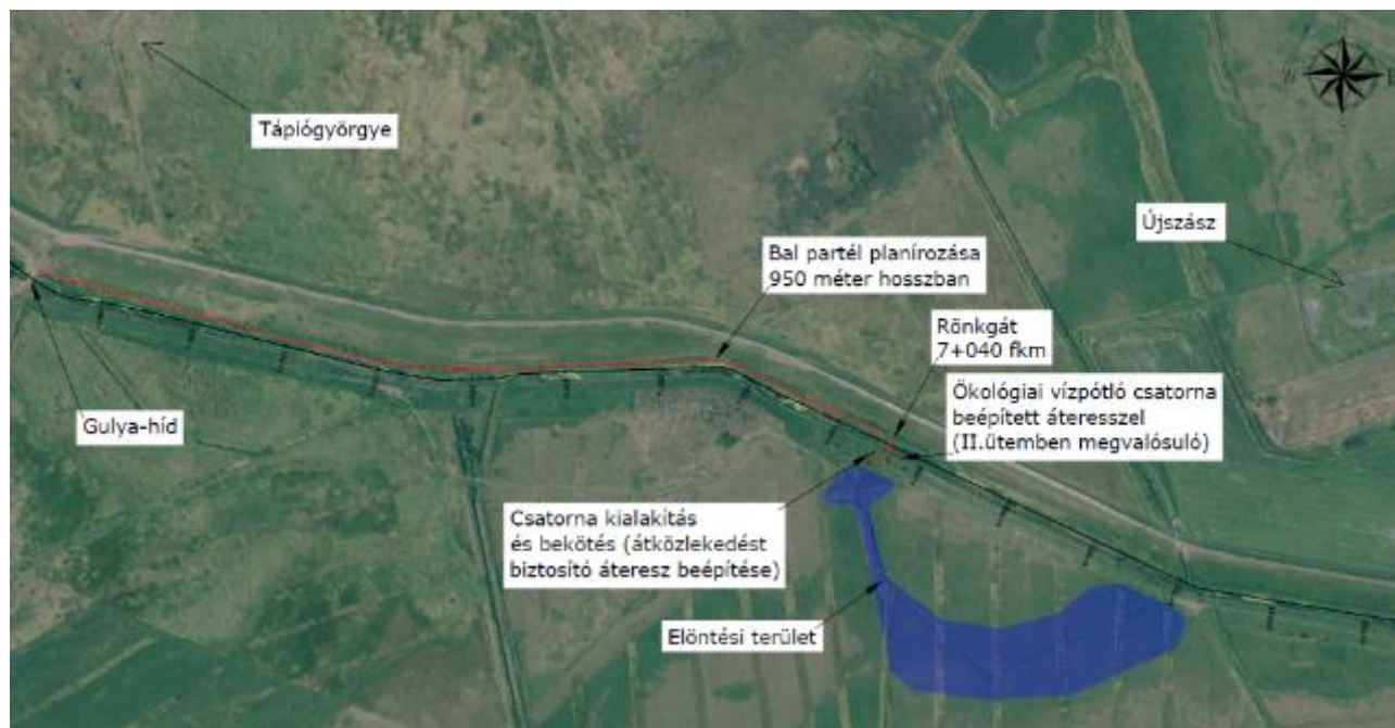
2. ábra Egyesült-Tápión létesítendő rönggát a 7+040 fkm szelvényében – átnézetes helyszínrajz (Forrás: KÖTIVIZIG – Vízügyi létesítési engedélyes terv)
