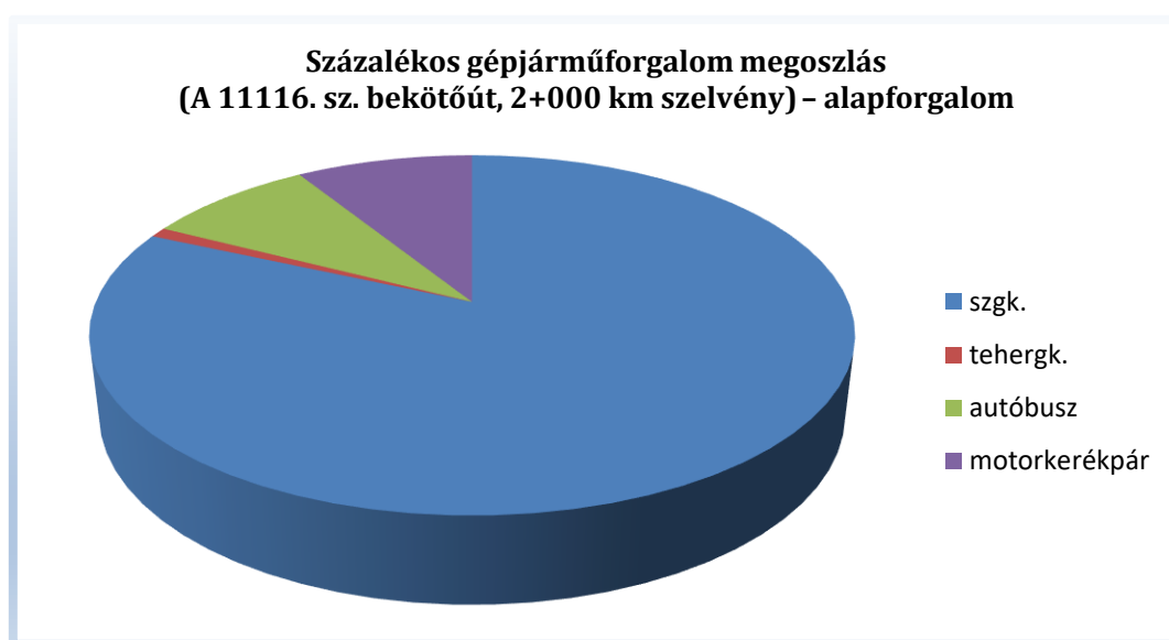
4.1. ábra: Százalékos gépjárműforgalom megoszlás (11116.számú bekötő út, 2+000 km) – alapforgalom
