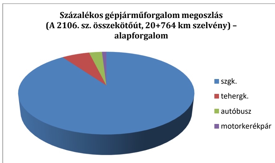
3. ábra: Százalékos gépjárműforgalom megoszlás (A 2106. sz. összekötőút, 20+764 km szelvény) – alapforgalom, amely nem tartalmazza a tervezett kiszállítás forgalmát
