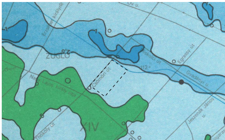
14. ábra A vizsgált terület talajvíz mélység térképe (forrás: Budapest területének földtani, vízföldtani, építéskalkulációs térképei, MÁFI, 1984, képernyőkivágat)
