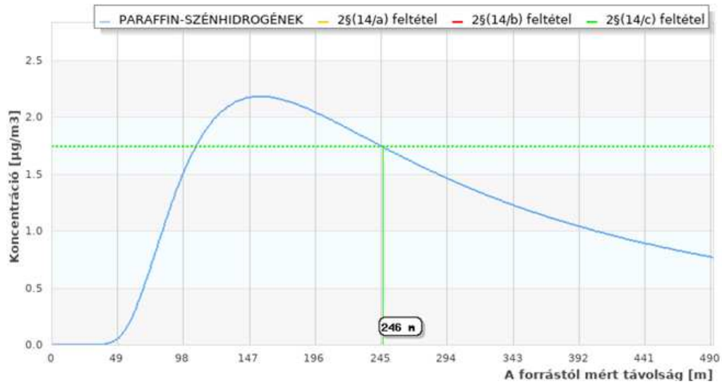
L9. ábra Légszennyezés-terjedés jellemzők P2 forrás esetén szénhidrogén légszennyezőre
