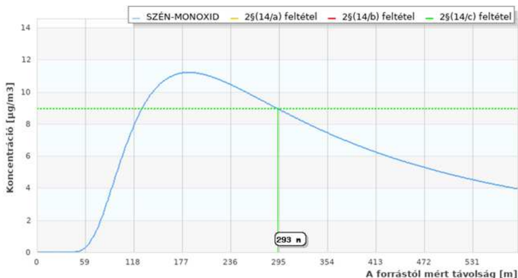
L5. ábra Légszennyezés-terjedés jellemzők P1 forrás esetén szén-monoxid légszennyezőre
