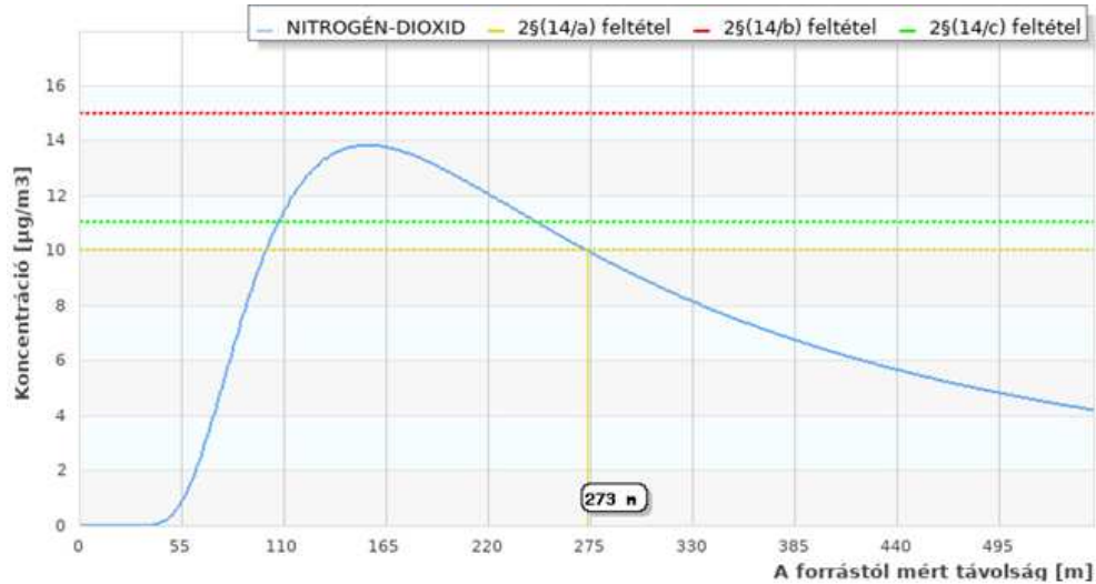
L7. ábra Légszennyezés-terjedés jellemzők a P2 forrás esetén nitrogén-dioxid légszennyezőre
