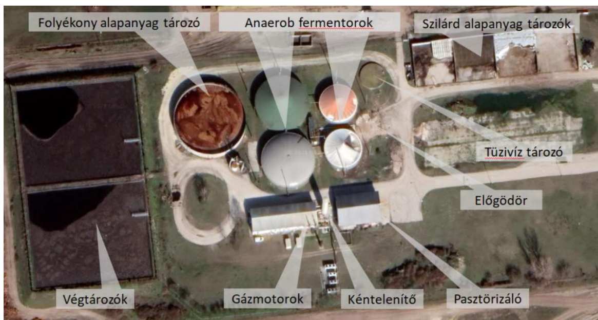
Á.2. ábra – A Dömsödi Biogáz Kiserőmű kialakítása és funkciói
