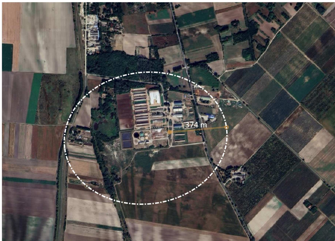
L16 ábra Levegőtisztaság-védelmi hatásterület térképi szemléltetése a telepi szagforrás esetén
