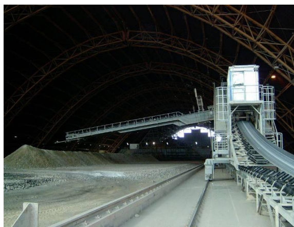
9. ábra: Chevron-rendszerű keverőágy és betároló gép
