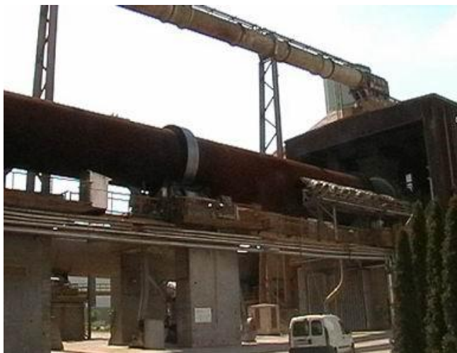
15. ábra: Klinkerégető forgókemence
