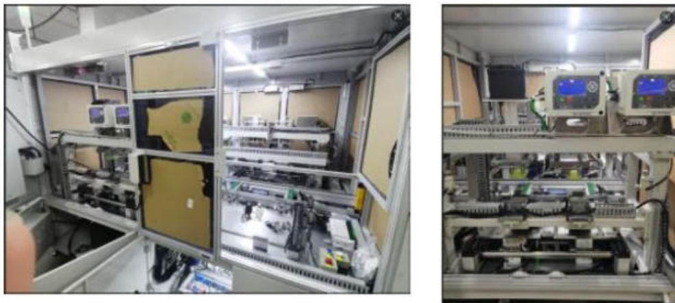
10. ábra: Légzárósági vizsgálat 10
