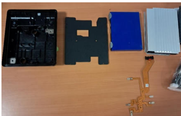
9. ábra: Akkumulátor modul részei 11
