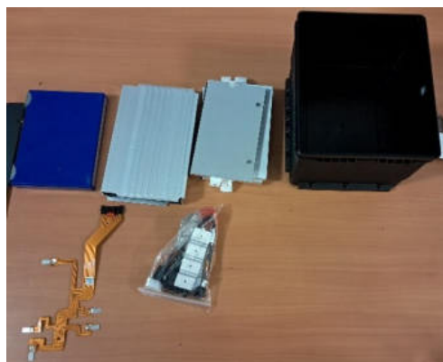
9. ábra: Akkumulátor modul részei 11
