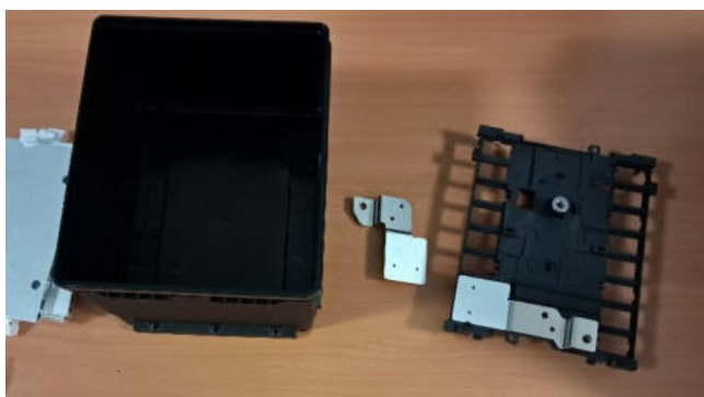
10. ábra: Akkumulátor modul részei
