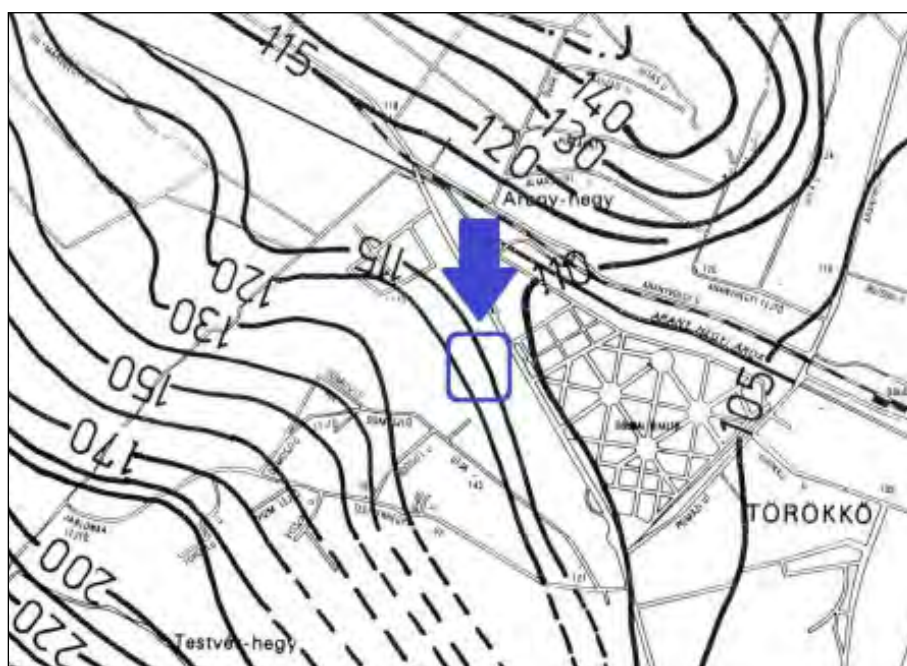
1-35. ábra A talajvíz maximális szintje és áramlási képe (Budapest Építéshidrológiai Atlasz, 1988)
