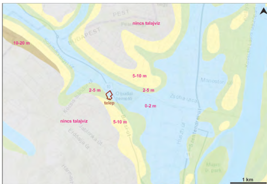
1-34. ábra A talajvíz jellemző mélysége (MBFSZ térkép alapján)
