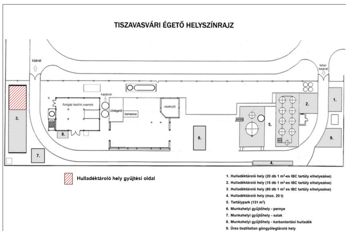
3. ábra: Hulladéktároló hely gyűjtési oldal a helyszínrajzon
