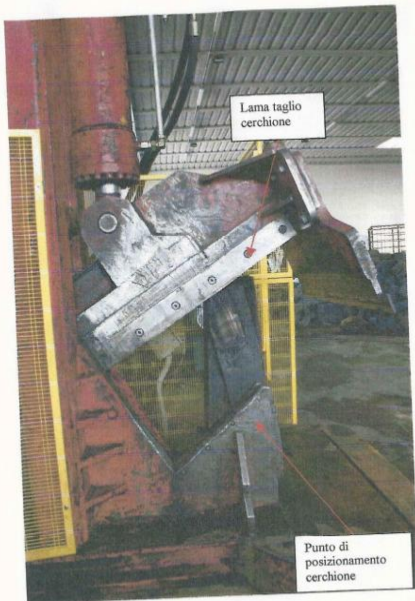
Fig. 3 Vista lato tranciatura pneumatico e cerchione
