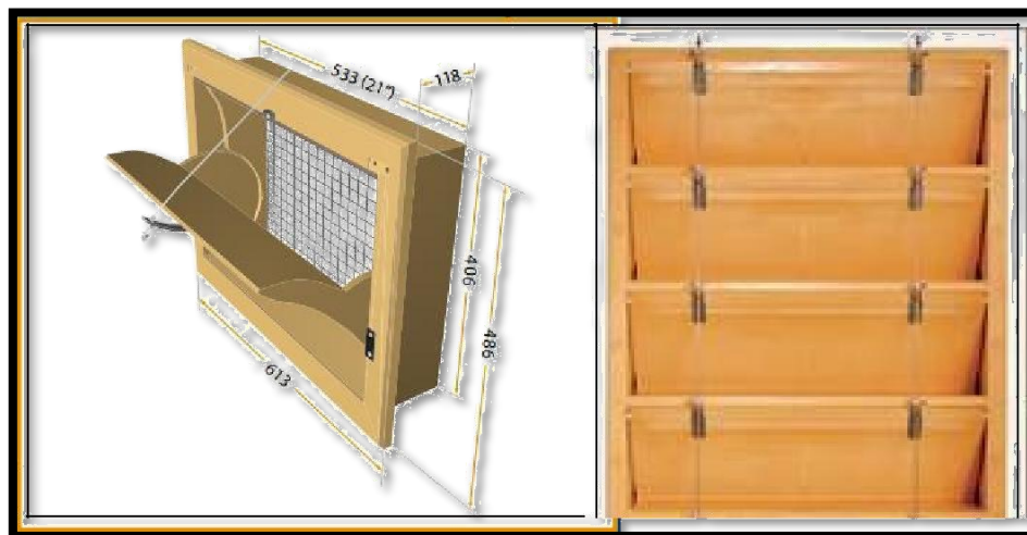
Légbeejtők felépítése
