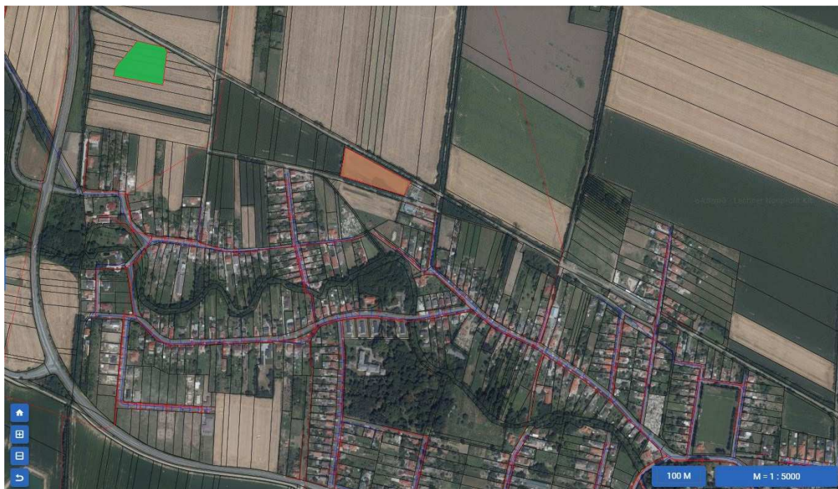
2. ábra.: szerkezeti módosítással érintett területek. zöld: általános mezőgazdasági terület és zöldterület, barna: különleges hulladékkezelő elhelyezésére szolgáló terület. piros vonal: villamoshálózat, kék vonal: vízhálózat
